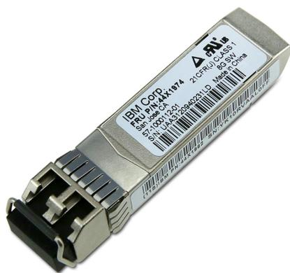
Ricetrasmittitore ottico IBM 44X1962 44X1970, 44X1974 8Gb SFP+ SW
