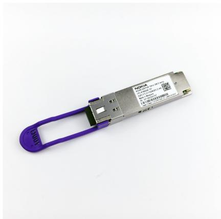
Originale Nokia 474829A.101 100G QSFP28 10km SM Modulo ricetrasmittitore E-temp FTLC1152WGPLC-NN
