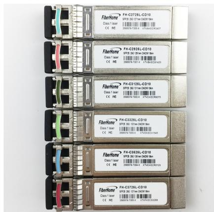
Modulo ricetrasmittitore FiberHome FH-C3325L-CD10 25G 1331nm 10km CWDM SFP28
