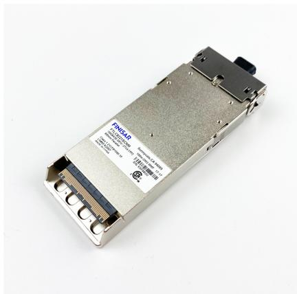
Ricetrasmittitore ottico II-VI Finisar 103.1Gb/s 100GBASE-SR10 e OTN Multirate 100m CFP2
