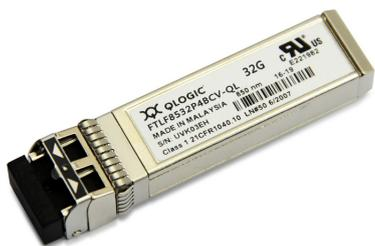
Genuine Qlogic FTLF8532P4BCV-QL 32G Fibre Channel 32GFC 850nm 100m Lunghezza d'onda corta SFP+ Ricetrasmittitore ottico
