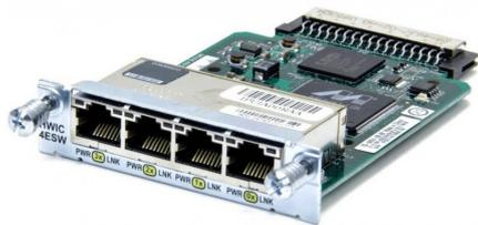
Cisco HWIC-4ESW-C Scheda di interfaccia switch Ethernet a quattro porte 10/100
