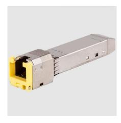
Aruba JL563B 10GBASE-T SFP+ RJ45 30m Ricetrasmettitore Cat6A JL563B
