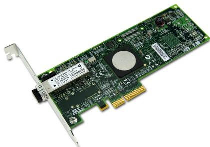
Emulex LPe1150 Adattatore bus host Fibre Channel PCIe 2.0 a porta singola da 4 Gb
