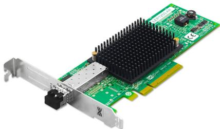
Adattatore bus host a porta singola PCIe 2.0 Fibre Channel Emulex LPe1250 da 8 Gb
