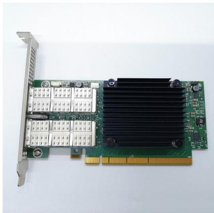
Scheda adattatore Mellanox MCB194A-FCAT Connect-IB doppia porta QSFP+ PCI Express Gen3 x16
