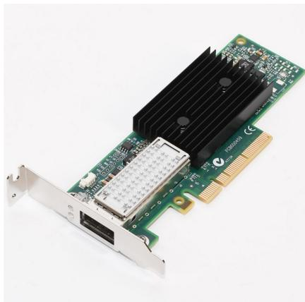
Scheda adattatore Mellanox MCX353A-FCBT ConnectX-3 VPI, singola porta FDR 56Gb/s o 40/56GbE QSFP, PCIe 3.0 x8 8GT/s
