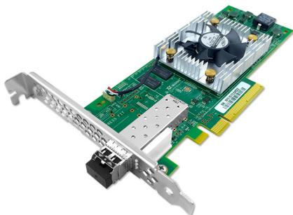
Adattatore Fibre Channel originale Qlogic QLE2670-CK PCIe 3.0 x8 a porta singola 16GFC SR-Optic a basso profilo da 16 Gb
