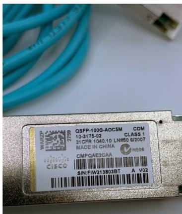
Cavo ottico attivo Cisco QSFP-100G-AOC5M 100G QSFP, 5 metri
