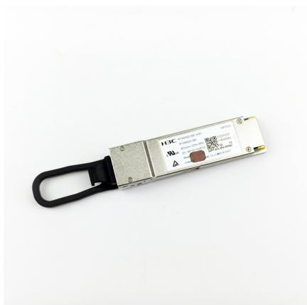
Modulo ricetrasmittitore ottico H3C 40GBASE-SR4 QSFP+ 850nm 150m DOM MTP/MPO MMF
