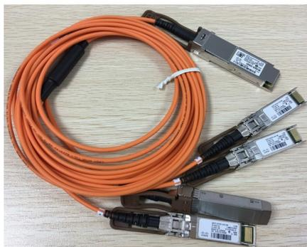
Cavo breakout ottico attivo Cisco QSFP-4X10G-AOC2M 40GBase-AOC da QSFP a 4 SFP+, 2 metri
