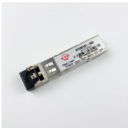
Modulo ricetrasmittitore WTD 1250M 550m 850nm MM ESFP
