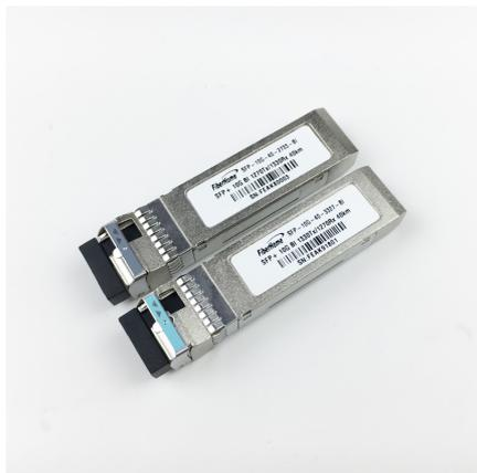
Modulo ricetrasmittitore FiberHome 10G SFP+ BIDI Tx-1270nm RX-1330nm 40 km
