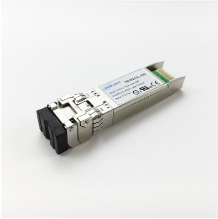
Modulo transceiver ottico originale Innolight 10Gb/s 10GBASE-LR/LW 1310nm 10km SFP+
